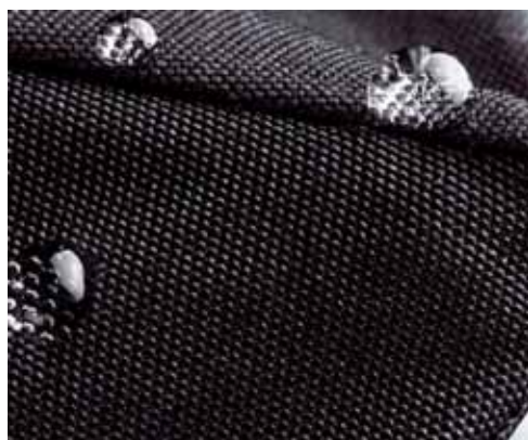
Figura 2: Superficie nanogranulada del tejido producido por Nanonuno® que induce la permanencia del agua en forma de gotas.
